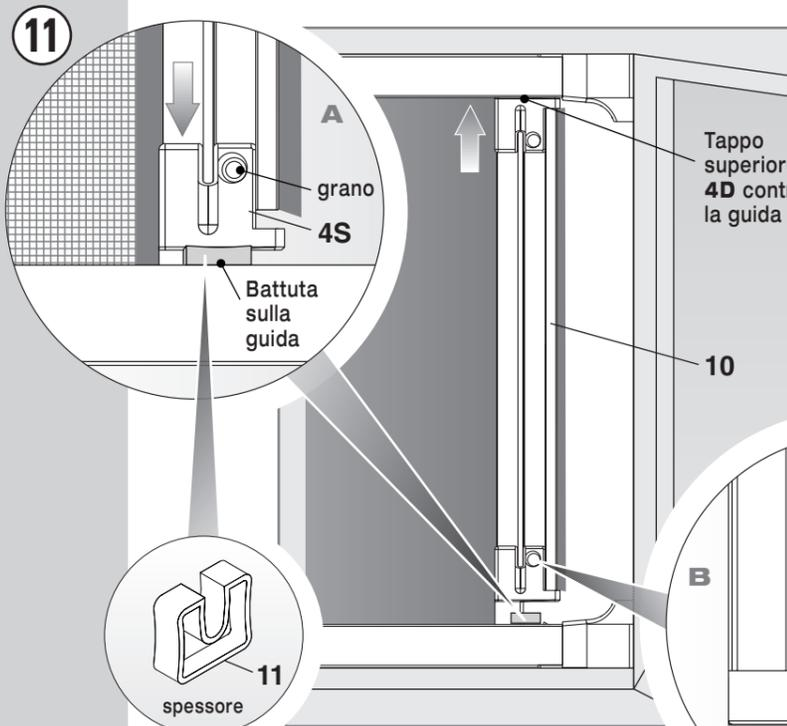
**11** **A** Inserire lo spessore 11 sul tappo inferiore 4S. Svitare il grano del tappo 4S e fare scivolare verso il basso il tappo stesso, finché non va a battuta sulla guida di scorrimento. Bloccare il grano del tappo, togliere lo spessore 11.
