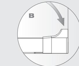
**B** Rimontare le guide di scorrimento nel vano finestra.
