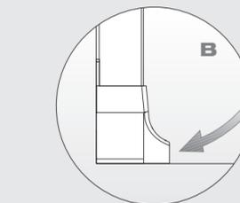
**B** Rimontare le guide laterali nel vano finestra.
